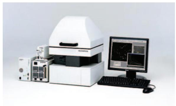
図1. 発光イメージングシステム LUMINOVIEW (LV200)、オリンパス社製
