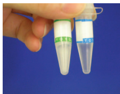
図2. -20℃保存での試薬の状態 従来品(緑)、本製品(青) 本製品は-20℃保存で凍結しません。
