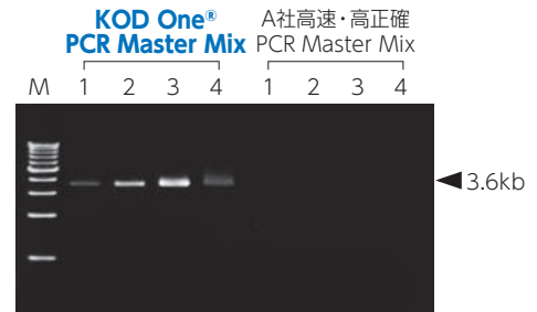
M: 1kb DNA Ladder 1: 血液1μL 2: 血液2μL 3: 血液4μL 4: 血液8μL
