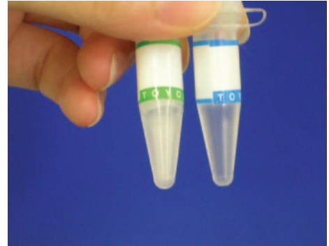
図1. -20℃保存での試薬の状態 従来品(緑)、本製品(青) 本製品は-20℃保存で凍結しません。
